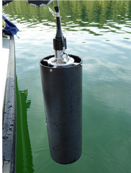
Bild 8.6: FluoroProbesonde für Tiefenprofilmessungen der Algenpigmente
