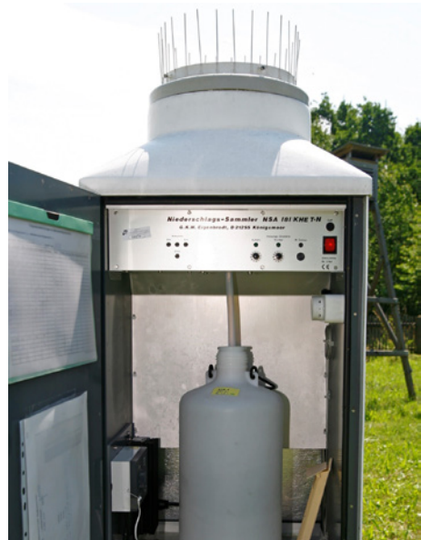
Bild 12.4: Thermostatisierter Bulk-Sammler (Trichter-Flasche-Prinzip) mit Vogelkrone
