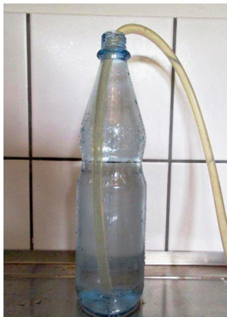
Bild 6.1: Probeentnahme mit Schlauch und radondichter Flasche (Foto: H. Zerbe, SGS INSTITUT FRESENIUS)
