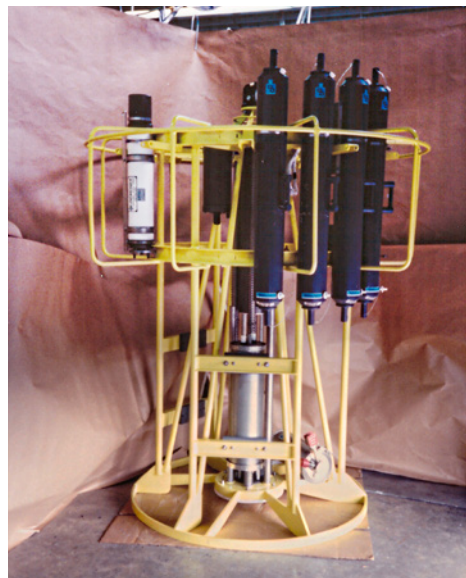
Bild 11.10d: Freifall-System mit akustischem Modem – links oben, CTD-Sonde – rechts unten und Bodenaufschlag-Dämpfer – Mitte unten (General Oceanics, Miami; [18])
