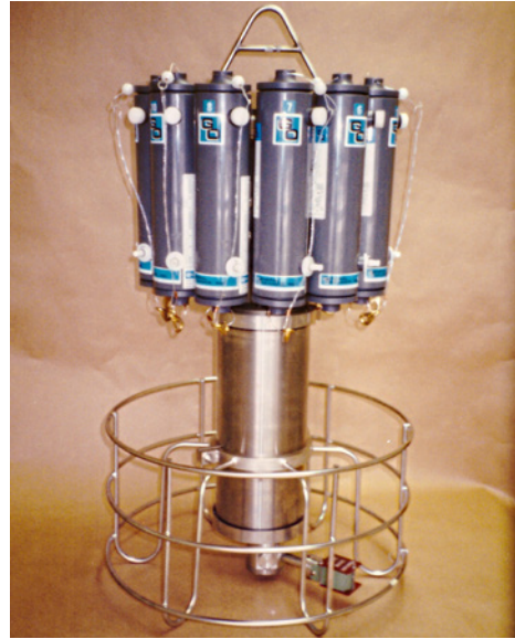
Bild 11.10b: 12-fach Rosette mit Niskinschöpfern und integrierter MK3C/WOCE-CTD-Sonde (Model 1016, General Oceanics, Miami; [18])
