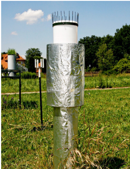
Bild 12.3: Einfacher Trichter-Flasche-Sammler (nach LAWA), geändert nach LfU: Ummantelung mit einer zweiten Röhre, inneres Rohr wassergefüllt, passive Kühlung durch Verdunstungskälte
