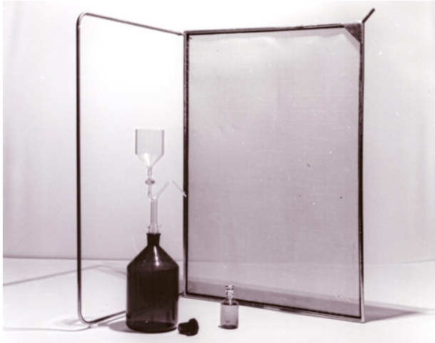
Bild 11.7: Edelstahldrahtnetz zur Entnahme von Oberflächen-Mikroschichtproben zur Analyse auf organische Spurenstoffe (Foto: Institut für Meereskunde, Rostock). Das Bild zeigt außerdem eine 2,5 l-Braunglasflasche zur Aufnahme und Extraktion der Mikroschichtproben, sowie einen darauf befindlichen Verdränger zur Abtrennung und eine 250 ml-Flasche zur Aufbewahrung des nach Ausschütteln mit einem organischen Lösemittel erhaltenen Extrakts.
