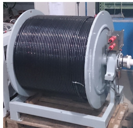
Bilder 11.4a und 11.4b: Pump-CTD-Winde mit Kabeltrommel. Das Wasser wird innerhalb des Kabels durch einen Teflonschlauch nach oben gepumpt (Foto: Krüger/Schuffenhauer, IOW).
