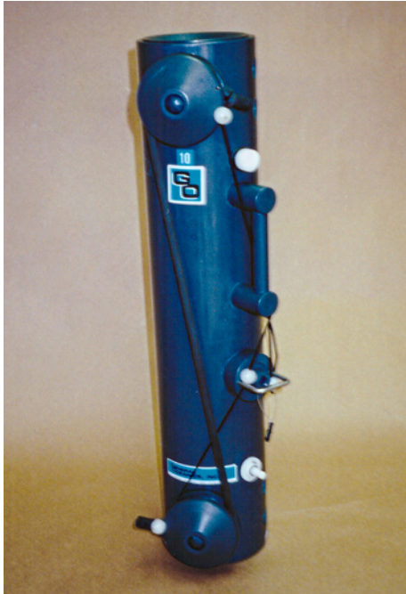
Bild 11.11: GO-FLO-Schöpfer aus PVC mit optionaler Teflon-Innenbeschichtung (General Oceanics, Miami; [18]). Der Schöpfer durchquert die Wasseroberfläche beim Fieren in geschlossenem Zustand und öffnet sich erst in etwa 10 m Tiefe über einen druckgesteuerten Releaser.
