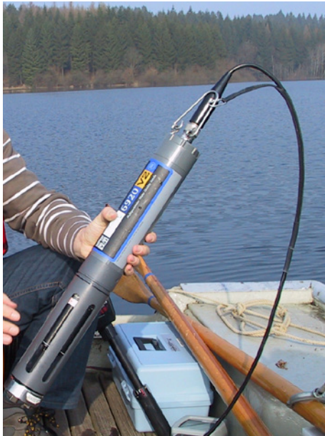
Bild 8.5: Multiparametersonde für Tiefenverteilung (Temperatur, Sauerstoff, pH-Wert, Leitfähigkeit, Trübung)
