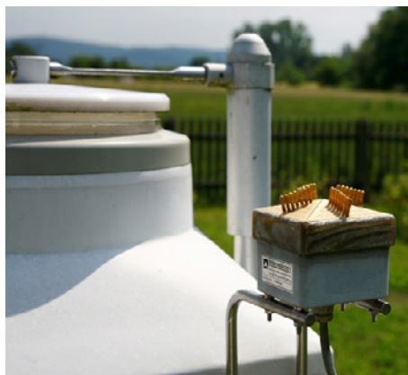
Bild 12.2: Detailaufnahme des Regensensors eines Wet-only-Sammlers
