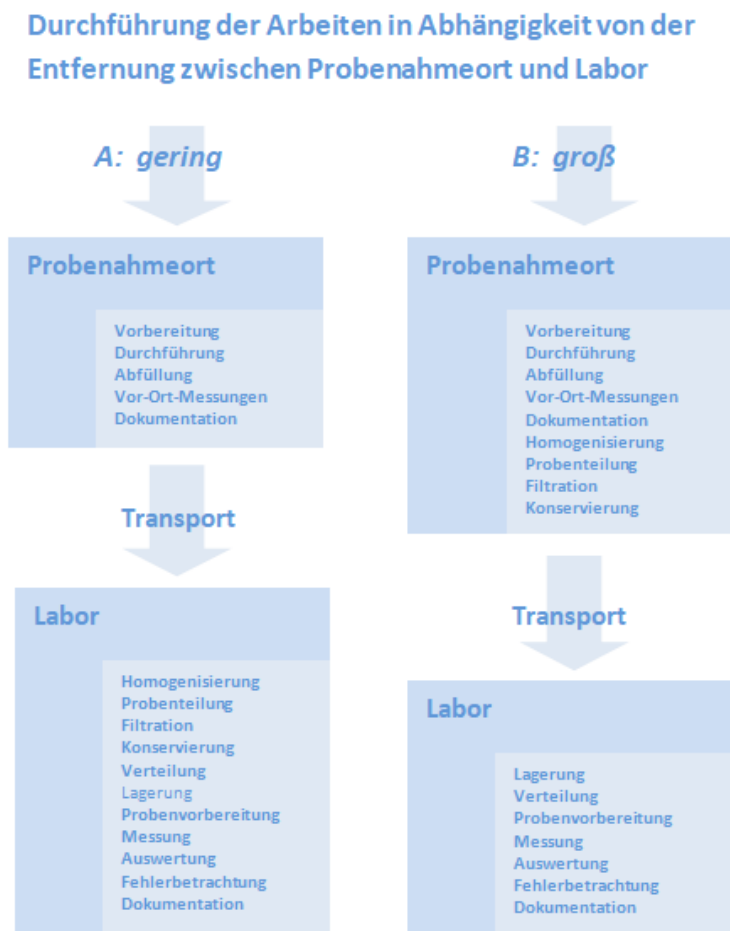
Bild 2.3: Schema zur Durchführung der einzelnen Arbeiten von Probenahme, Probenvorbehandlung und Analyse in Abhängigkeit von der Entfernung zwischen Probenahmeort und Labor
