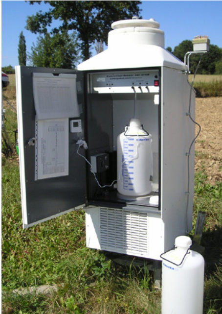
Bild 12.1: Wet-only-Sammler mit Trichterverschluss (schwenkbarer Deckel), Regensensor und thermostatisiertem Probenraum
