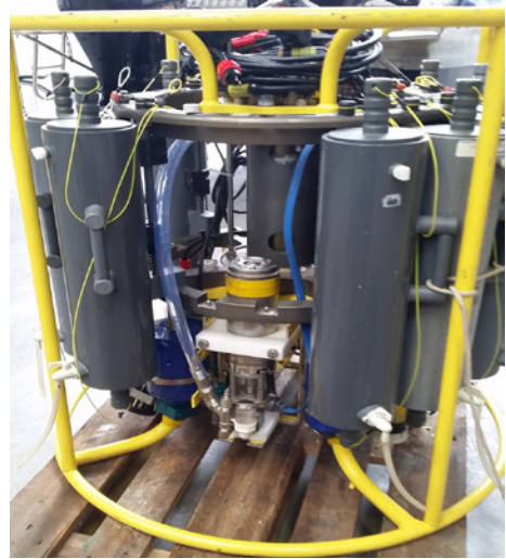
Bild 11.3: Pump-CTD mit Wasserschöpfen, Pumpe und Sensoreinheit (Foto: Krüger/Schuffenhauer, IOW)
